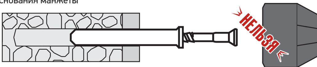
3. устанавливают дюбель в основание и забивают гвоздь через прикрепляемый материал
