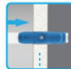
Резьба внутреннего профиля препятствует прокручиванию шурупа, обеспечивая плотный прижим.
