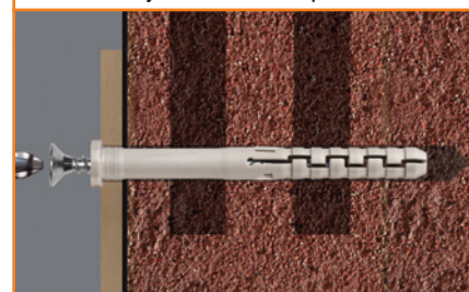
В пустотелом кирпиче
