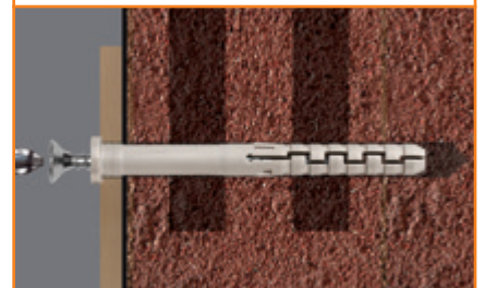
В пустотелом кирпиче
